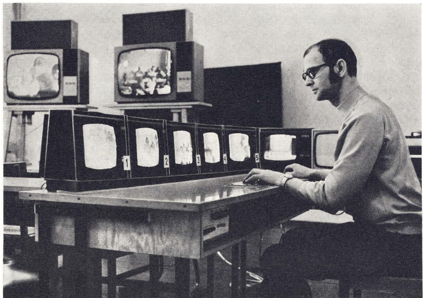
3 Mitschauraum. Regiepult mit Monitoren, Tonverstärker und dem Videorecorder mit Kontrollmonitor. Im Hintergrund die vor der Tafel zusammengeschobenen Bildschreiber mit den aufgesetzten Lautsprechern
